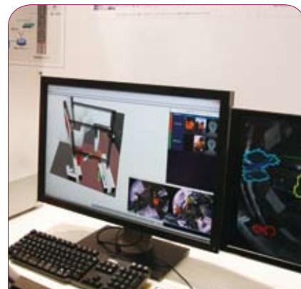
監視カメラの映像を分析して不審者検知を行うセコムのシステム
