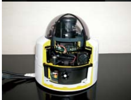
パートナーやユーザーにSDシリーズの強度、耐衝撃性をわかりやすくするために、筐体を切断したSDシリーズの断面。
